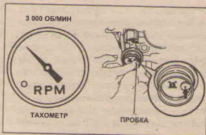
8.7 Увеличьте частоту вращения двигателя до 3000 об/мин, закройте пальцем отверстие вакуумного передающего клапана и отпустите дроссельную заслонку - частота вращения двигателя должна упасть до указанной в тексте
