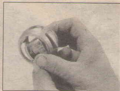
12.13 Выведите одно из уплотнений внутреннего кольца в одно из больших окон сепаратора, затем поместите кольцо в сепаратор
