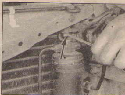
16.7 Открутите четыре монтажных болта и снимите конденсатор
