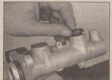
8.8b После снятия бачка вытяните из корпуса цилиндра уплотнительные кольца; если кольца затвердели или повреждены, замените их
