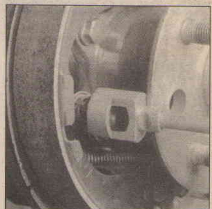
6.4f Сожмите пружину опорной стойки и поверните стойку на 90°, затем вытяните ее конец из отверстия в колодке - плоскогубцы вполне подойдут для этого действия, но подобный специальный инструмент намного облегчит работу
