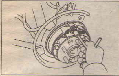
12.3 Отцепите стяжные пружины колодок стояночного тормоза - специальный инструмент значительно упростит эту задачу
