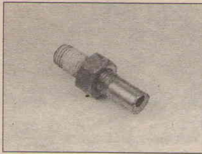
4.7 При отсутствии специального топливного манометра Toyota и требуемого 8 мм банджо-болта, возьмите обычный болт на 8 мм, зажмите его в тисках, срежьте головку, высверлите сквозное отверстие в болте, наверните контргайку и уплотните резьбу изоляционной лентой
