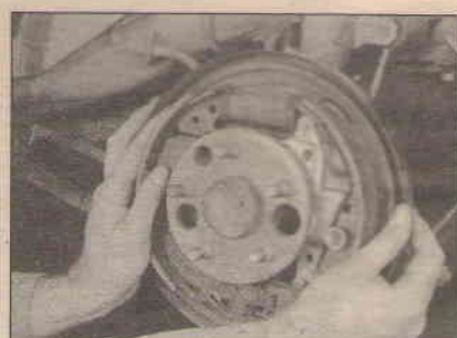
6.4x Пошевелийте сборку, чтобы все компоненты заняли правильное положение относительно друг друга
