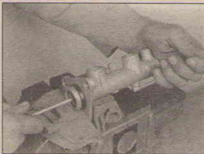
8.9 Нажмите на поршни крестообразной отверткой, затем снимите болт ограничителя; не забудьте заменить при сборке медную шайбу (прокладку) болта ограничителя
