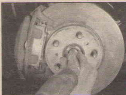
10.6 Молотком и медным пробойником резко ударьте по концу приводного вала, чтобы он сместился на пазах (не вгоняйте его слишком глубоко)
