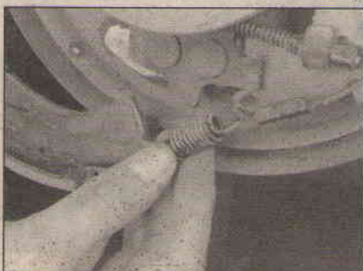
6.4u Подцепите нижнюю стяжную пружину к основанию каждой из колодок и поместите на опорный щит переднюю колодку; установите опорную стойку колодки, ее пружину и опорные чашки
