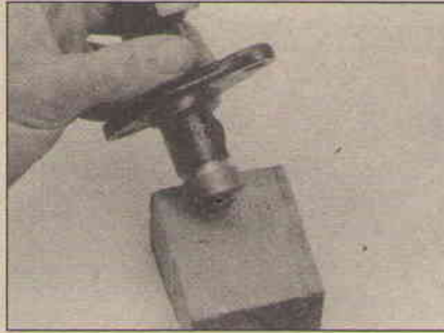
5.8 Переверните цилиндр и пристукните им по деревянному бруску, чтобы вытряхнуть поршень
