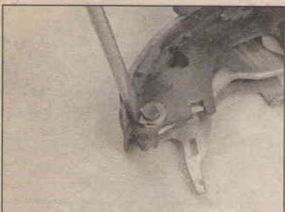
6.4m Отожмите фиксирующую шайбу и снимите ее, чтобы отделить рычаги стояночного тормоза и разжимной планки от задней колодки.
